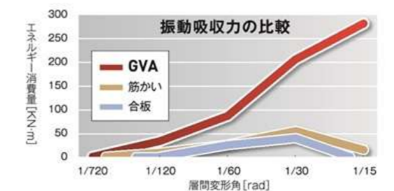
従来型の耐力壁と比較し安全限界1/30rad時において約4倍の消費量の差が確認されました。
